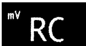
**FR** Si à la fin de l'étalonnage le display affiche "rc", appuyer sur le bouton Cal pour revenir à la lecture. Répéter la procédure d'étalonnage, si le message "rc" réapparaît, cela signifie que l'électrode n'est pas en bon état et qu'elle doit être changé.
