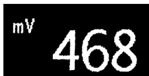
**FR** Appuyer pendant 3 secondes sur le bouton CAL, la valeur 468 commencera à clignoter sur le Display. L'étalonnage est fait automatiquement et il se termine quand la valeur sur le Display redévient fixe.
