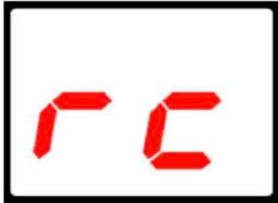
3) Si à la fin de la calibration l'afficheur indique "rc", appuyer sur CAL pour sortir et retourner à la lecture du pH. Répéter la procédure. Si après une seconde tentative il apparaît encore "rc", la sonde pH est défectueuse et doit être changée.
