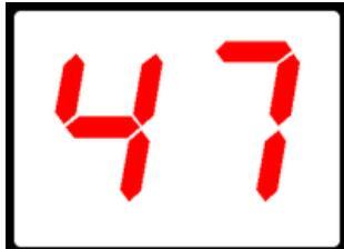
**F** Appuyer sur CAL pendant 3 secondes, la valeur 470 va clignoter sur l'afficheur. La calibration 468mv est automatique, se terminant quand la valeur sur l'afficheur devient fixe.
