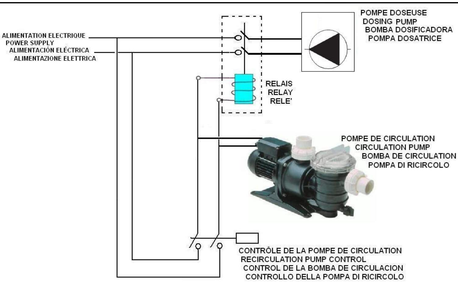
**F** ! IMPERATIF ! La pompe ne doit injecter que lorsque de l'eau circule dans la canalisation.
