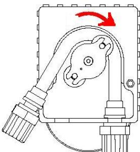
**E** Remover la tapadera transparente destornillando las dos tornillos sobre la fachada. Sacar el viejo tubo desbloqueando primera el racor de izquierda, girando en el sentido de la flecha el portarodillo de modo que liberar el tubo hasta el racor de derecha.
