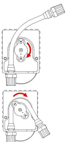
**F** Positionner le raccord de gauche du nouveau tube péristaltique dans l'encoche prévue à cet effet. Faire attention à ce que la partie arrondie soit orientée vers l'intérieur. Tourner le porte-galet dans le sens horaire de façon à ce que le tube péristaltique se mette naturellement en place.
