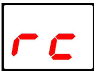
**F** Si à la fin de la calibration l'afficheur indique "rc", appuyer sur CAL pour sortir et retourner à la lecture du Rx. Répéter la procédure. Si après une seconde tentative il apparait encore "rc", la sonde Rx est défectueuse et doit être changée.
