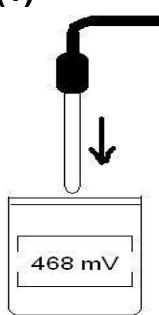
**F** Insérer la sonde Rx dans la solution tampon 468mV. Attendre quelques secondes pour que la lecture se soit stabilisée.
