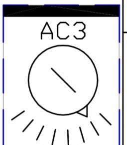
Calibrer le disjoncteur en fonction de la puissance de la pompe
